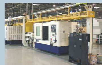
桁架机械手智能一体化生产线。
