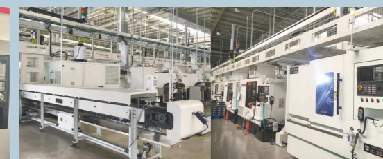
一汽120米多机自动化集成生产线现场 (桁架机械手选配)
