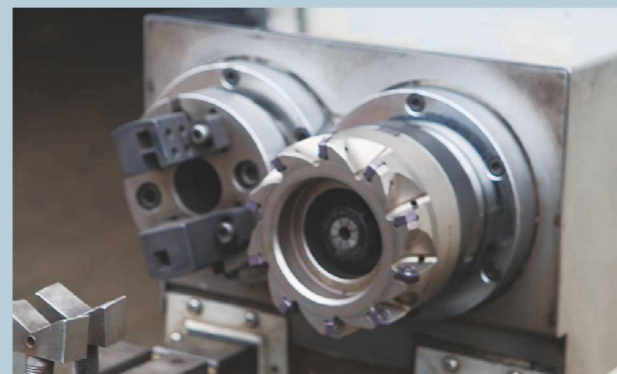
JX500平床身系列单 / 双主轴 适合直径50以下铣单面打中心孔铣端面打中心孔镗孔。
